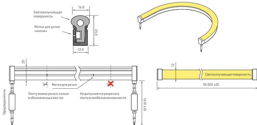
Вывод кабеля питания выполнен с двух сторон перпендикулярно линии сечения герметичной ленты «неон». Длина кабеля питания —  $1610 \pm 10$  мм.
