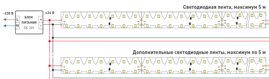
Схема 2. Подключение нескольких светодиодных лент с двух сторон. Рекомендуется использовать для обеспечения равномерного свечения ленты по всей длине.
