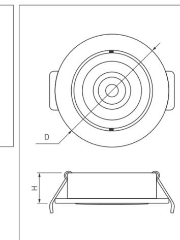
Рефлектор особой конструкции обеспечивает освещение под углом 10°, 25°, 30°, а наклоняемая ось позволяет изменять направление светового потока. Корпус изготовлен из алюминия, окрашен высококачественной порошковой краской белого цвета и обеспечивает эффективное отведение тепла от светодиода.
