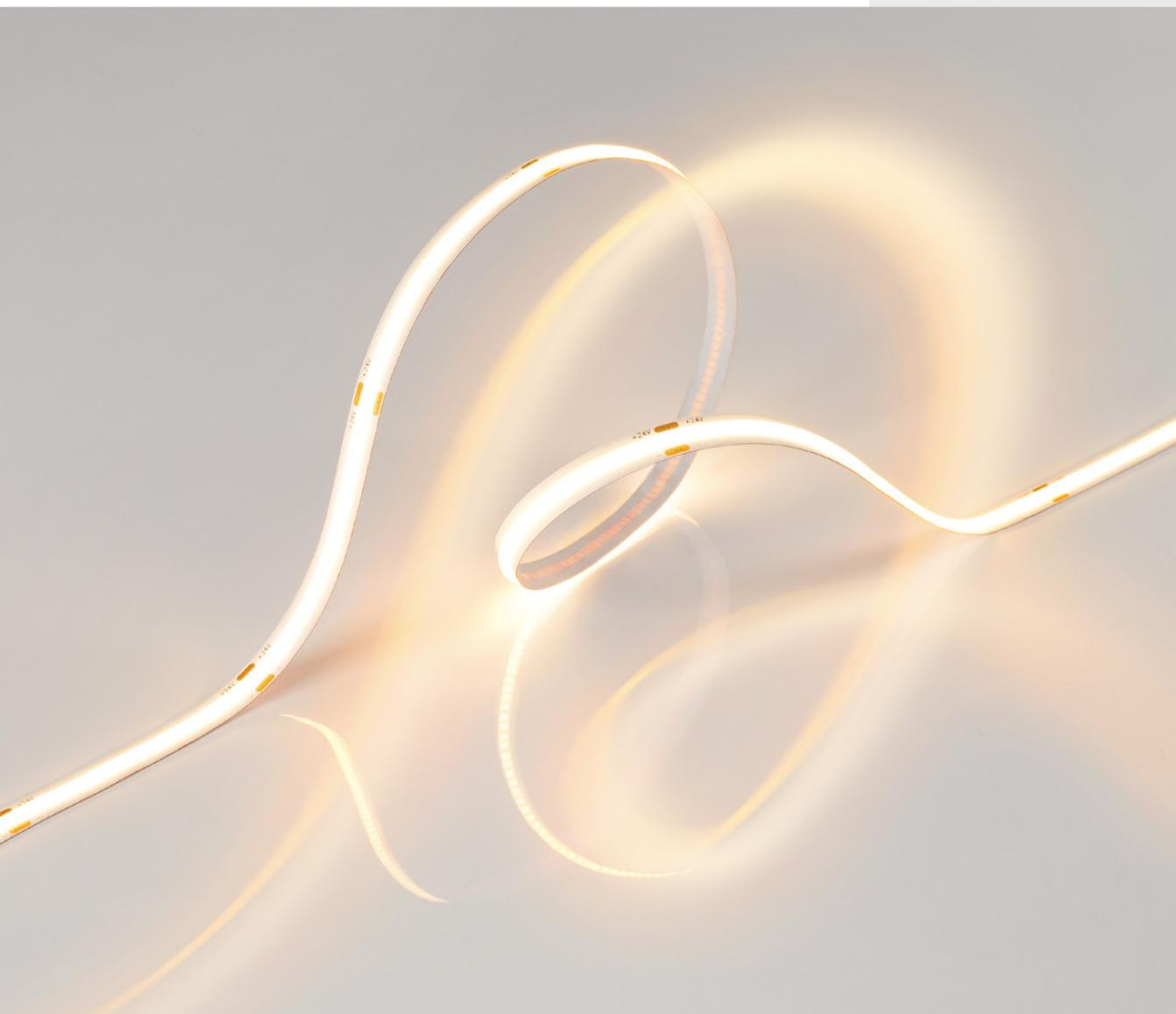
Основное преимущество лент линейки COB — эффект сплошной линии света без применения рассеивателей. За счет заливки люминофором по всей длине ленты образуется равномерное свечение без видимых точек светодиодов. Большой выбор лент по мощности, ширине платы, плотности кристаллов и цвету свечения позволяет реализовать разные типы освещения.
