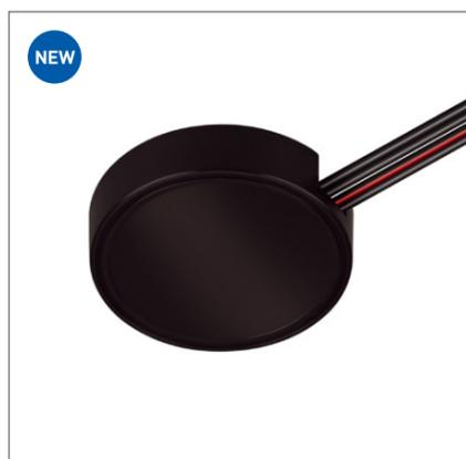
Встраиваемый диммер для зеркал, установка в отверстие 16 мм. Функция включения/выключения срабатывает при поднесении руки на расстояние до 10 см. При удержании руки над датчиком более 1 с изменяется яркость в диапазоне 3-100%.
