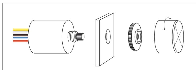
Схема крепления диммера
