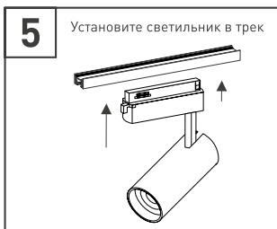
Рис. 2. Установка и подключение светильника
